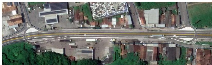
Figura 23. Desenho funcional da conexão das ruas Dr. Jessé Fortes /Cremildes Freire com a Rodovia BR-101
